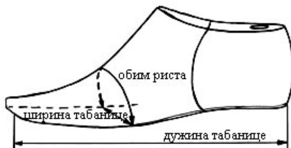
Слика 1 – Основне димензије калупа за ципеле
