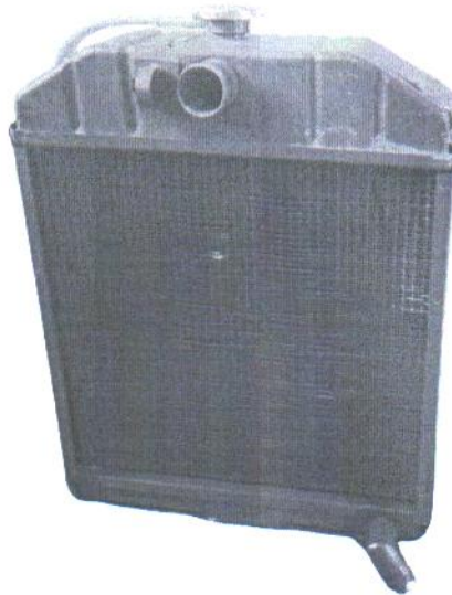
Слика: Хладњак за електроагрегат ADP-15
