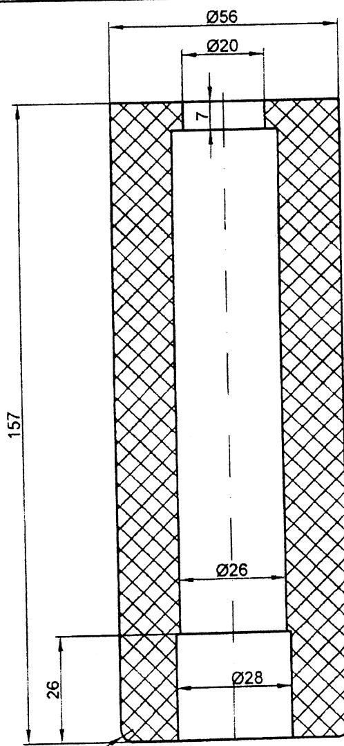
NAPOMENA: Guma je ekspandirana (u sirovu gumu staviti primeće koje u procesu vulkanizacije proizvode mikro pore)
